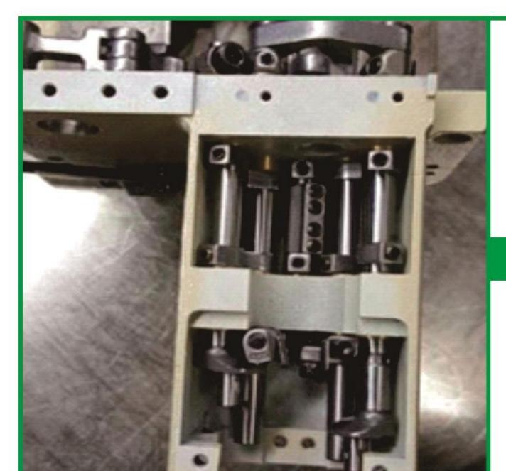
专利设计的五轴心下巴机构, 结构更合理,为机器高速运转 的稳定性提供了强有力的保
