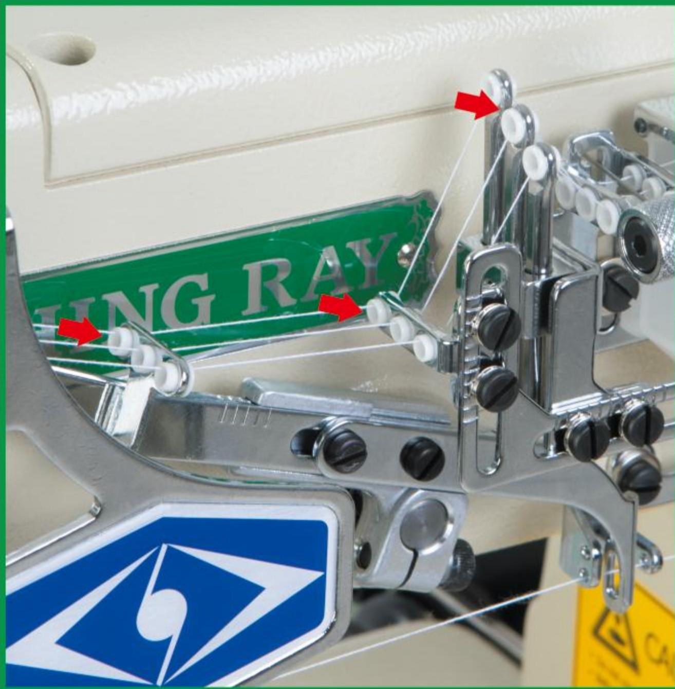
采用新型陶瓷过线结构,穿线简单,过线顺滑,有效的延长机器使用寿命。
