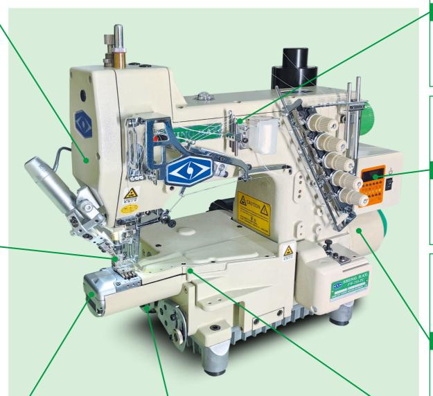
采用隐藏式针棒设计, 简化陶瓷过线结构, 车缝更 顺滑,不跳针、不断线, 线迹更美观。
